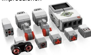
Steuerungscomputer mit Motoren und Sensoren
