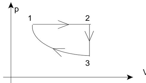
b) Zustand 1 :  $p = 800'000 \text{ Pa}$ ,  $V_1 = 0.3 \text{ l} = 3 \cdot 10^{-4} \text{ m}^3$
