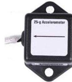
Der Beschleunigungsmesser misst die auftretende Beschleunigung über einen integrierten Schaltkreis, welcher auch in Autos verwendet wird, um die Auslösung der Airbags zu kontrollieren. Dieser Schaltkreis ist mit sehr feinen "Fingern" ausgestattet welche in Silikon eingebettet sind und sich bei Beschleunigung biegen. Diese sind wie Platten in einem Kondensator angeordnet. Wirkt nun eine Beschleunigung auf den Schaltkreis, so biegen sich diese Finger, was zu einer Änderung der Kapazität führt.
