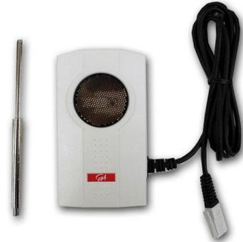
Die Messung der Distanz eines Objekts wird bei diesem Sensor mittels der Zeitspanne die der Ultraschallpuls vom Emitter zum Objekt und wieder zurück braucht, gemessen. Der Bewegungssensor kann über Gewinde an der Unterseite und an den beiden Seiten an einer kurzen Stativstange befestigt werden. Während der Messung ist vom Schallsensor stets ein leises Klicken zu vernehmen. Der Sensor kann Bewegungen im Abstand von 20 cm bis zu 6 m (im Idealfall sogar bis zu 12 m) erkennen.
